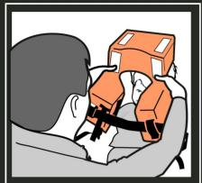
DON LIFEJACKET PLACING YOKE OVER HEAD AND BELT AROUND BODY
